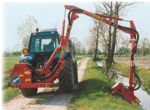
fac-simile tipologia di trincia a sbraccio per passaggi multipli orizzontali ed inclinati
