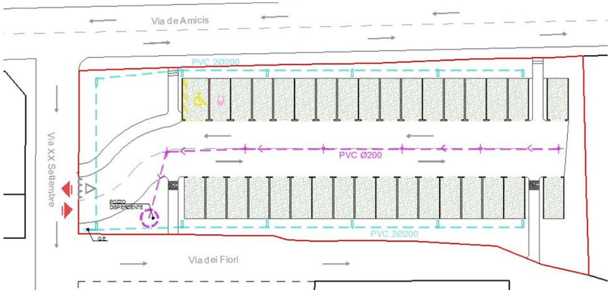
Schema di raccolta delle acque meteoriche (in viola) con indicazione del pozzo perdente. Schema della rete di dell'impianto di illuminazione LED (in azzurro).
