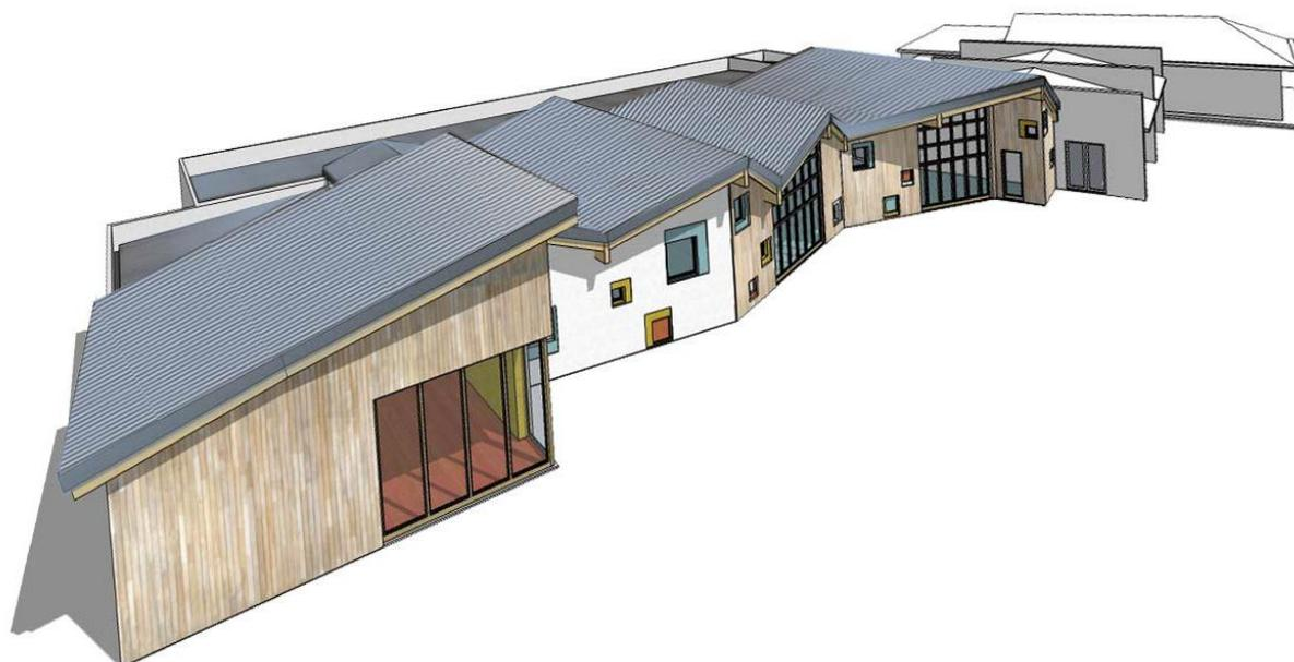
L'intervento prevede la realizzazione di un edificio scolastico destinato a Scuola Elementare Primaria con n. 5 classi per 27 alunni cadauna, su un'area di circa 3.000 mq. Il progetto prevede la realizzazione di un edificio ad un piano fuori terra e di un'area esterna in parte pavimentata e
