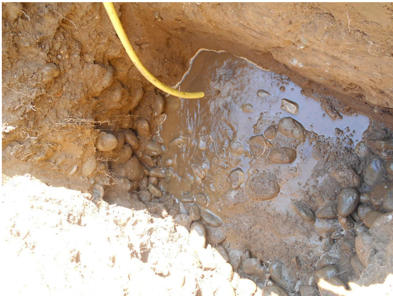
Figura 9: Immissione di acqua nel pozzetto P2
