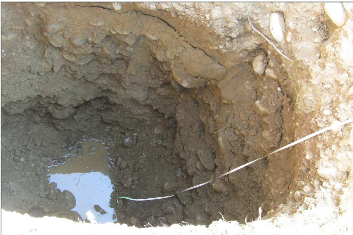
**Figure 6 a-b:** immagini fotografiche dello scavo geognostico SG1-BO, eseguito nell'area in esame. Nella prima immagine è possibile vedere l'intera successione stratigrafica attraversata, nella seconda si evidenzia la presenza di acqua sotterranea alla profondità di 2,7 m da p.c.
