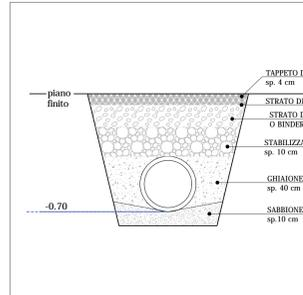
**SCHEMA SEZIONE TIPO POZZO PERDENTE**
